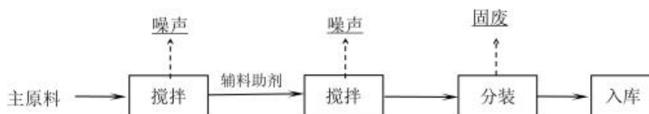
图 3-4 清洁剂、离型剂、洗模剂、强化液生产工艺流程图
